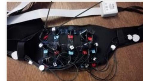
Abbildung 2: fNIRS - Messstirnband (Headband 8x7)
